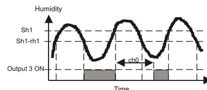
La salida 4 se utiliza de la misma manera pero controlada por el Sh2, usando rh2 como diferencial, ch3 como indicador de conexión directa o inversa, y ch1 como el mínimo tiempo de paro.
