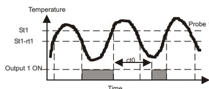
La salida 2 se utiliza de la misma manera pero controlada por el St2, usando rt2 como diferencial, ct3 como un indicador de conexión directa o inversa, y ct1 como el mínimo tiempo de paro.
