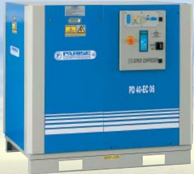
Con un nuovo sistema di raffreddamento siamo riusciti ad ottimizzare al massimo le prestazioni mantenendo bassi anche i costi per la manutenzione. Il flusso d'aria principale che raffredda il radiatore non passa attraverso il compressore, ma viene direttamente espulso verso l'alto; in questo modo oltre ad avere un ottimo raffreddamento, l'aria evita di rilasciare polveri e sporco all'interno della macchina.
