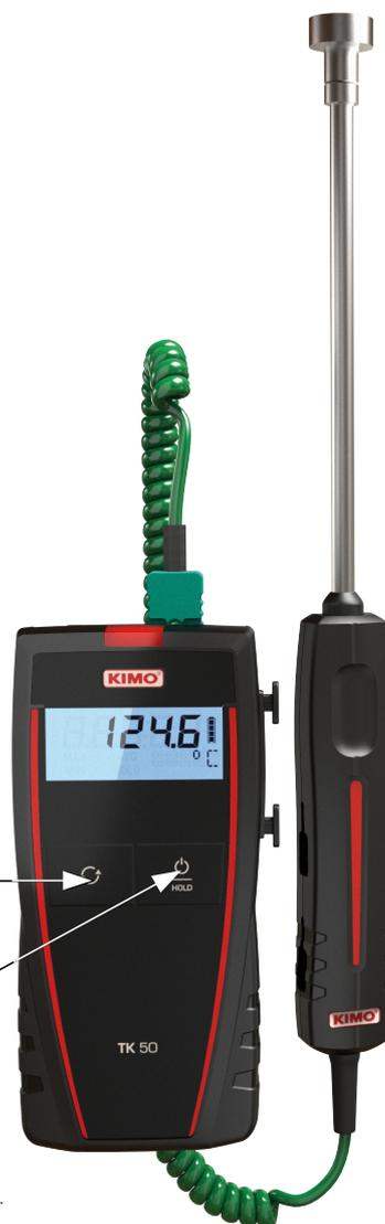
Apagado automático: el instrumento se apaga automáticamente si no ha sido usado durante 20 minutos.
