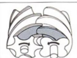
Fig. 4 La compresión continúa hasta que el espacio queda expuesto al puerto de salida, por donde escapa el gas
