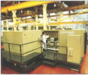
Centro de fabricación de rotor CNC en funcionamiento
