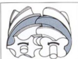
Fig. 2 Al encajar los rotores el gas queda atrapado entre ellos y la carcasa
