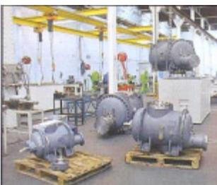
Ensamblaje de un compresor WRV inyectado de aceite
