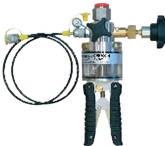
Bomba de comprobación hidráulica, modelo CPP700-H
