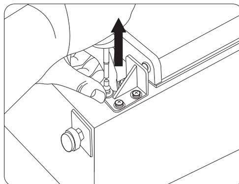
2. Retire la puerta de la bisagra superior derecha. Luego retire la manga de la bisagra de la parte superior de la puerta.
