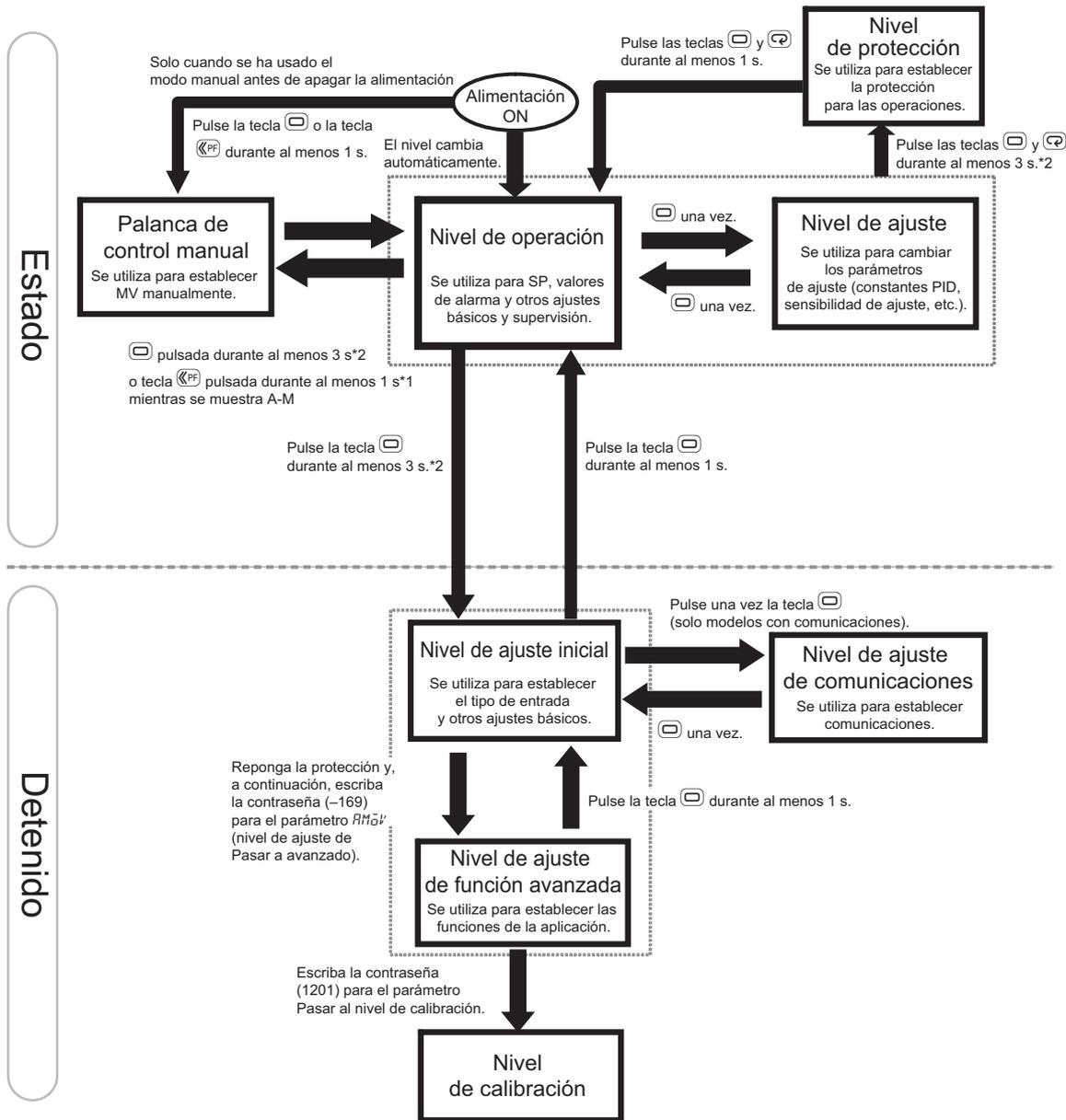
\*1. Para utilizar un procedimiento de teclas para pasar al nivel de control manual, ajuste el parámetro de adición de selección manual/auto en ON y el parámetro de ajuste PF en  $R-M$  (Auto/Manual).
