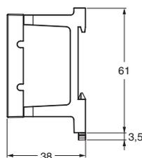
Este adaptador se usa para montar el E5CC en un carril DIN. Si usa el adaptador no es necesario el montaje de una placa en el panel ni practicar en él taladros de montaje.
