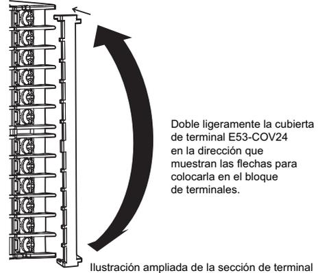
Doble ligeramente la cubierta de terminal E53-COV24 en la dirección que muestran las flechas para colocarla en el bloque de terminales.
