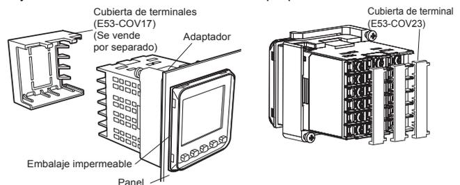
1. Para el montaje impermeable, se debe instalar el embalaje impermeable en el controlador. La impermeabilidad no es posible cuando se montan varios controladores en grupo. El embalaje impermeable no es necesario cuando no se necesita la función de impermeabilidad.
