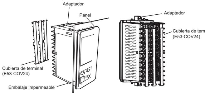
1. Para el montaje impermeable, se debe instalar el embalaje impermeable en el controlador. La impermeabilidad no es posible cuando se montan varios controladores en grupo. El embalaje impermeable no es necesario cuando no se necesita la función de impermeabilidad.
