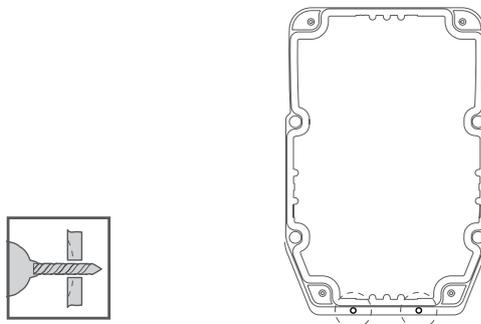
2. Realice los orificios de fijación a la pared en las áreas previstas del lado posterior de la base del cuadro.
