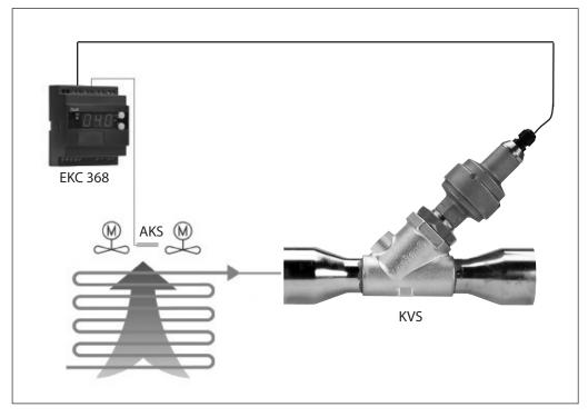
Les vannes KVS fonctionnent par activation à régulation électronique du moteur pas-à-pas AST. Il s'agit d'un moteur bipolaire à deux phases qui ne tourne, dans un sens ou dans l'autre, que lorsque les deux bobines distinctes du stator du moteur sont excitées par les impulsions de puissance d'une alimentation.
