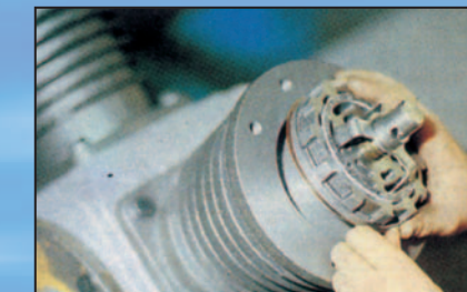
Montaggio della valvola concentrica completa di preminvalva Assembly of the concentric valve complete with valve presser.
