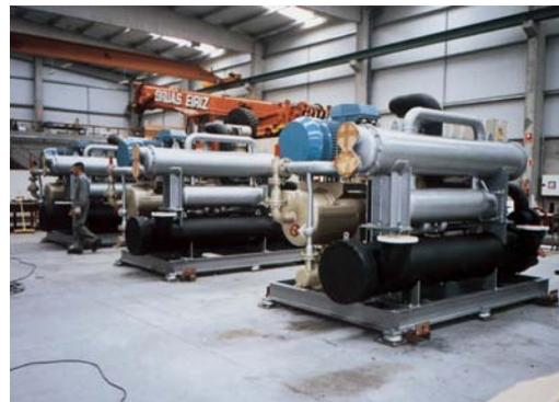
Unidades enfriadoras de agua para acondicionamiento del Ferry Volcán de Tamasite, de Naviera Armas. Cada una tiene 580 kW de potencia frigorífica.
