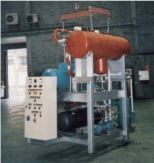
Carga de unidad condensadora de 50 kW de potencia frigorífica a  $-40/+40^{\circ}\text{C}$  para atender armarios verticales en un matadero.
