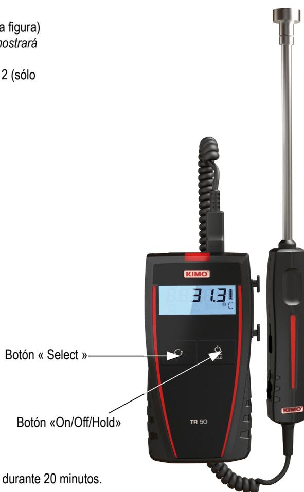
Apagado automático: el instrumento se apaga automáticamente si no ha sido usado durante 20 minutos.
