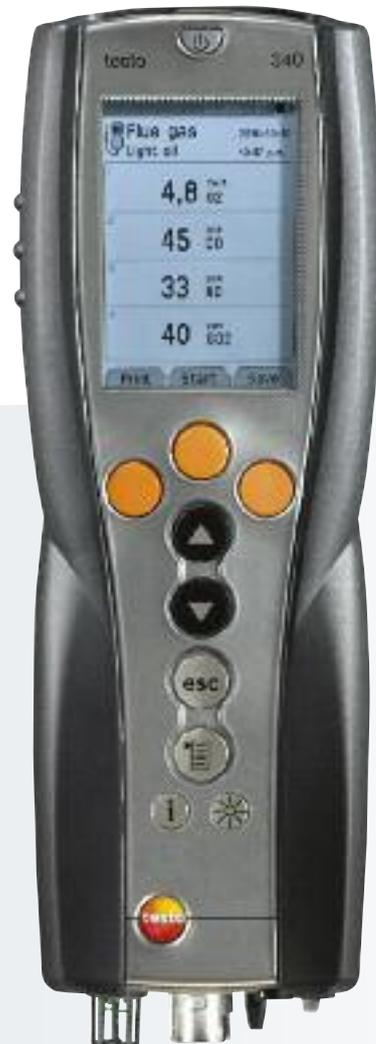
El incremento de los costes en carburantes para sistemas térmicos resaltan todavía más la necesidad de una monitorización eficaz mediante la medición de las emisiones. En estos casos resulta ideal disponer de un analizador de combustión práctico y sencillo de usar.. El testo 340 es el analizador portátil para el análisis de combustiones industriales con ventajas tales como:
