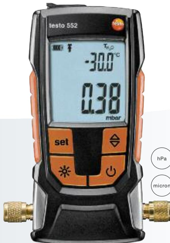
El testo 552 es un vacuómetro digital para la generación de vacío en sistemas de refrigeración y bombas de calor. Mide con exactitud incluso presiones absolutas extremadamente bajas y proporciona información exacta sobre el grado de deshumectación de un sistema (eliminación de sustancias no deseadas como aceites o gases).
